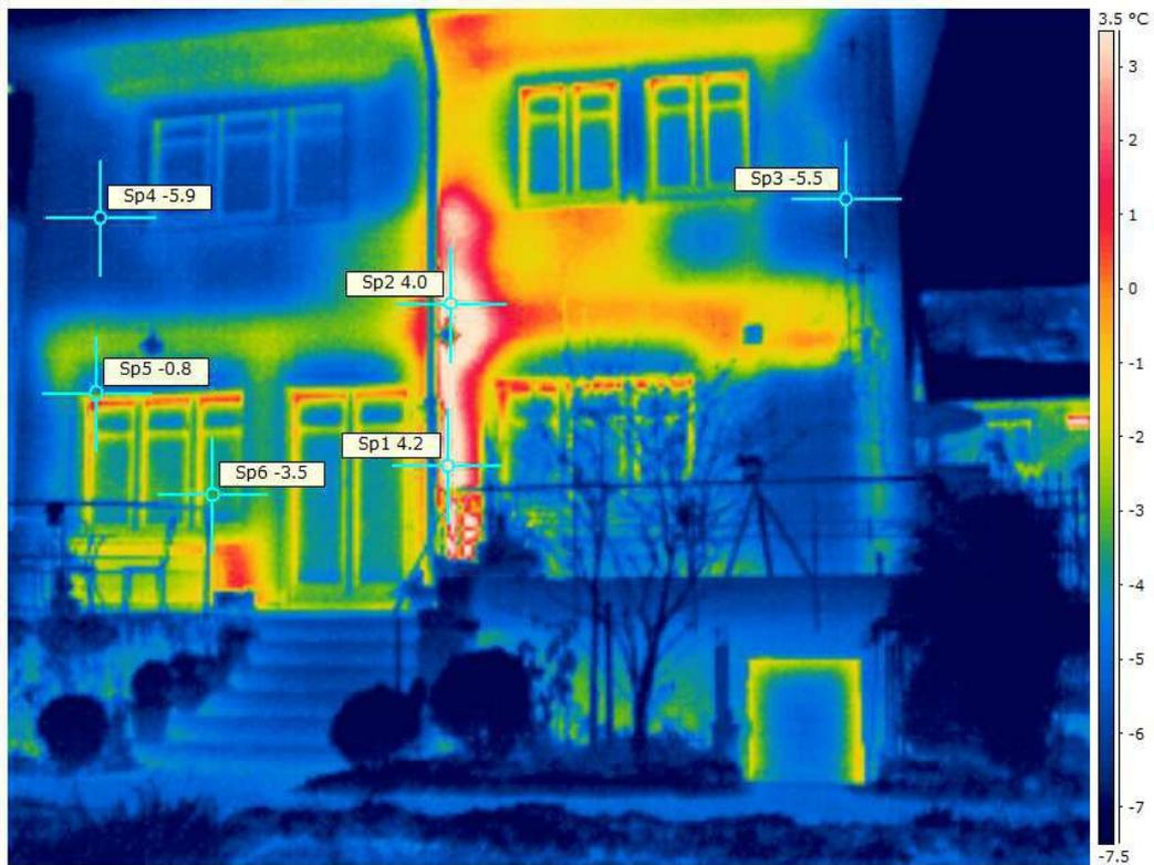
Auch hier ist ganz offensichtlich eine Heizungsleitung sehr schlecht gedämmt. Unter den Fenstern werden die Heizkörper außen sichtbar. Ebenso zeichnen sich die Rollladenkästen an der Außenfassade ab.
