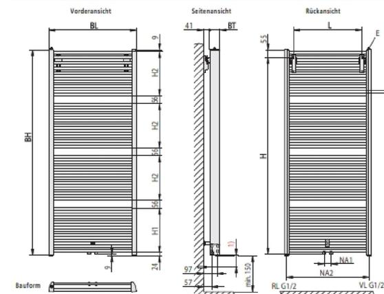
Abstand Unterkante Heizkörper zu Boden min. 135 mm.
